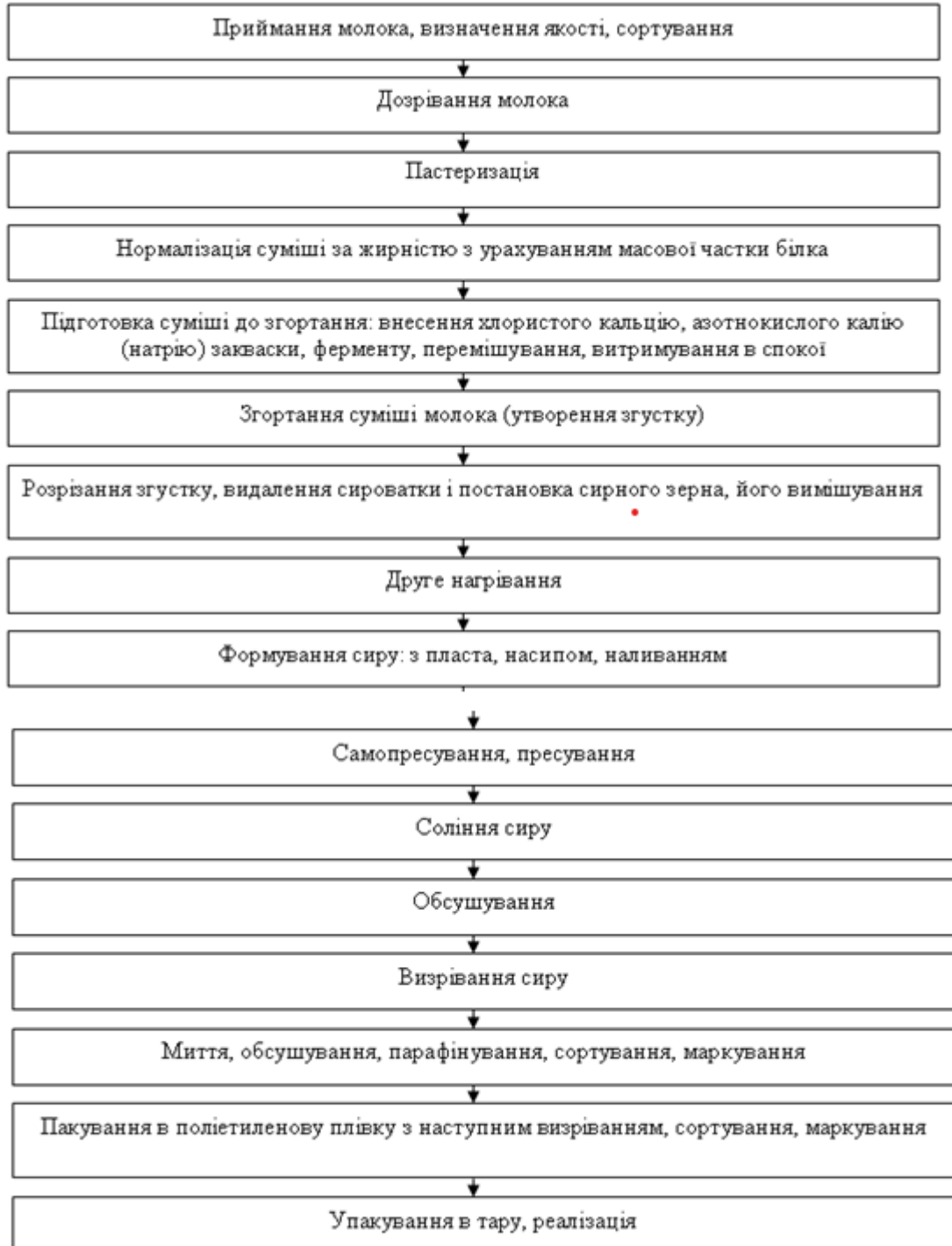
Рис. 3.1. Загальна технологічна схема виробництва сичужних сирів.
