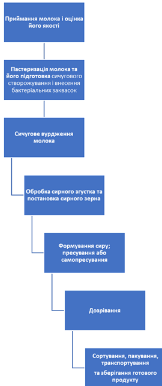
Рис. 3.2. Опис процесу виготовлення твердих сичугових сирів.
