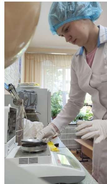
Рис. 3.3.2.1. Визначення чистки води у маслі за допомогою СМП-84
