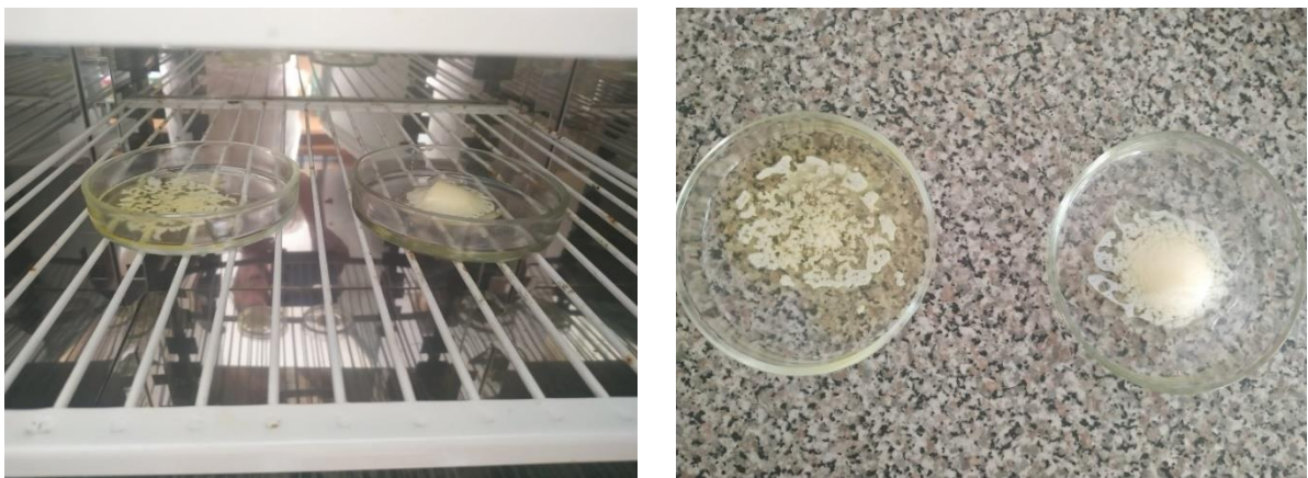
Рис. 3.3.2.3 Дослідження температури плавлення жиру у зразках за допомогою термостату (№1 – праворуч, №2 – ліворуч)
