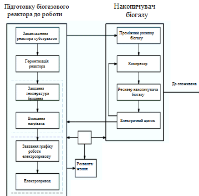
Рис. 2.5. Технологічний процес отримання біогазу.
