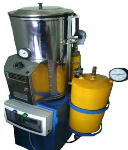
Рис. 2.1. Загальний вид малооб'ємної біогазової установки
