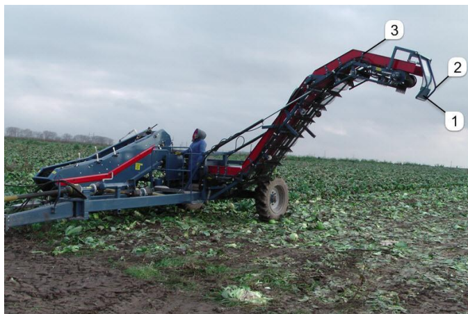
Рис. 1.17. Капустозбиральний комбайн ККП - 1: 1 – щиток; 2 – рамка; 3 – елеватор
