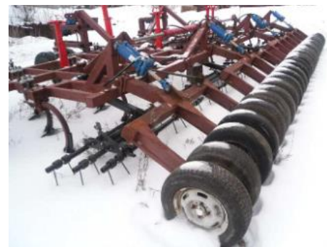
Рис. 2.2. Загальний вигляд причіпного широкозахватного посівного комплексу з робочими органами в транспортному положенні
