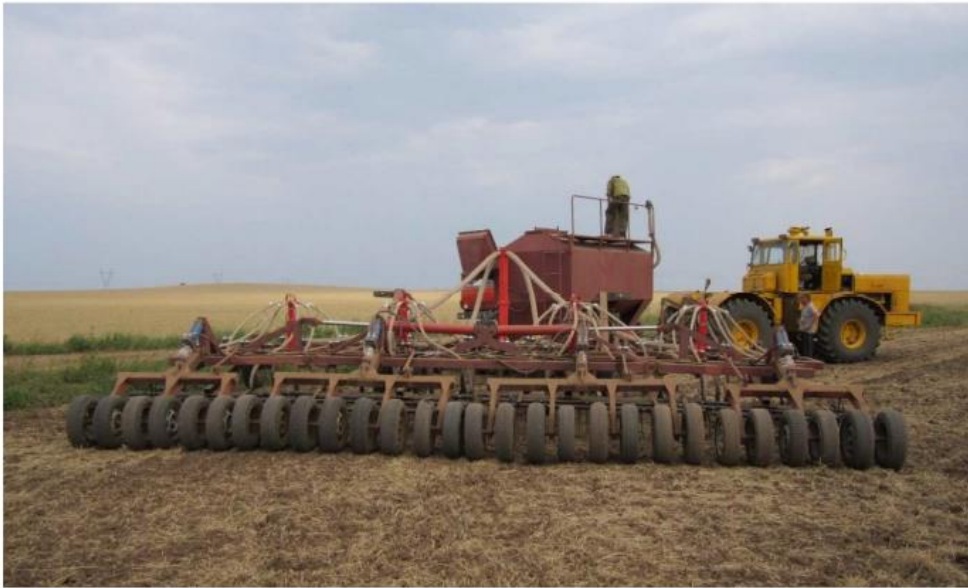
Рис. 2.5. Загальний вид причіпного широкозахватного посівного комплексу «AGRAER-850H» під час польових робіт при сівбі зернових культур
