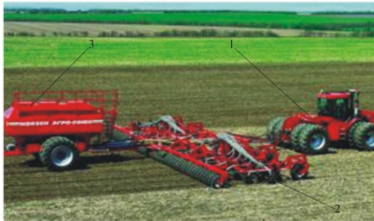
Рис. 1.3. Загальний вигляд посівного комплексу «HORSCH АГРО-СОЮЗ»: 1 – енергетична установка (трактор HORSCH -К-735); 2 – важкий культиватор; 3 – бункер із пневматичною висівною системою.
