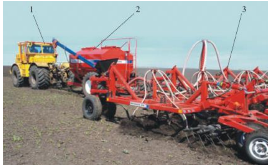
Рис. 1.5. Загальний вигляд посівного комплексу «Агратор-8500»: 1 – енергетична установка (трактор К-701М); 2 – бункер із пневматичною висівною системою; 3 – культиватор.
