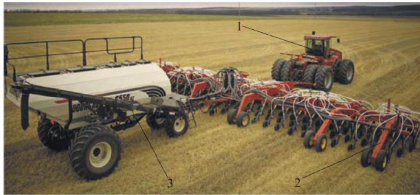
Рис. 1.2. Загальний вид посівного комплексу «BOURGAULT» 3320se PHD: 1 – енергетична установка (трактор HORSCH-K-735); 2 – важкий культиватор; 3 – бункер з пневматичною висівною системою
