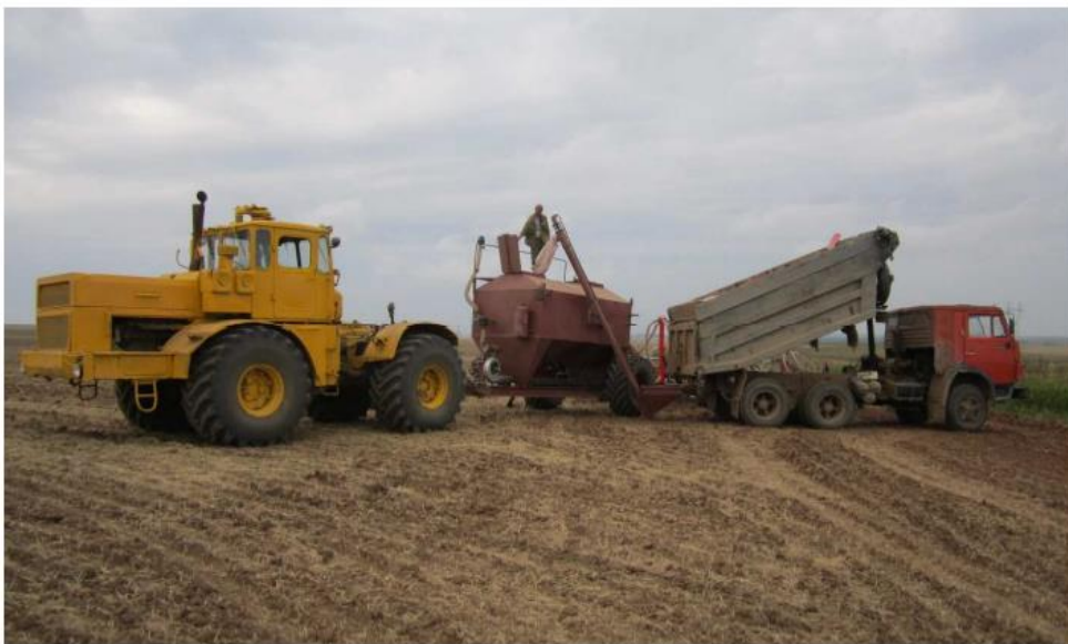
Рис. 2.4. Загальний вигляд причіпного широкозахватного посівного комплексу «AGRAER-850Н» при заправці бункера зерном та добривами
