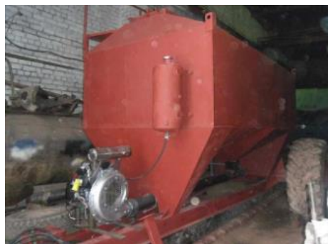
Рис. 2.2. Загальний вигляд причіпного широкозахватного посівного комплексу з робочими органами в транспортному положенні
