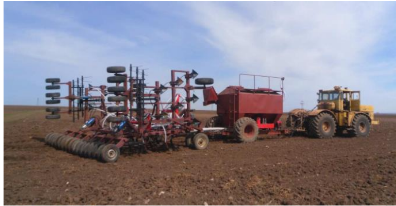
Рис. 2.2. Загальний вигляд причіпного широкозахватного посівного комплексу з робочими органами в транспортному положенні
