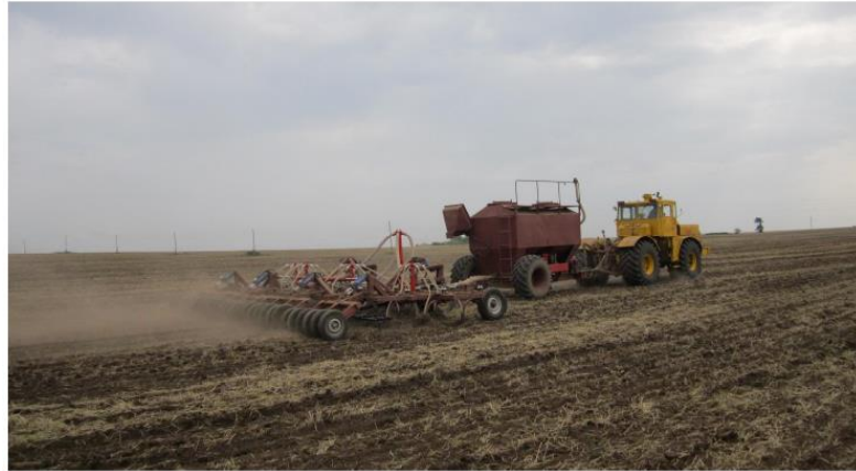
Рис. 3.2. Загальний вид причіпного широкозахватного посівного комплексу «AGRAER-850H» у процесі сівби зернових культур по стерні
