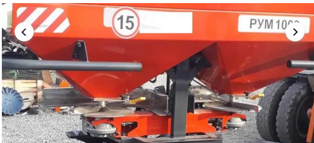
Рис. 1.4. Розкидач мінеральних добрив з візком РУМ 1000
