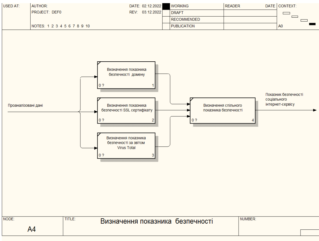
Рисунок 1.7 – Діаграма декомпозиції другого рівня для процесу визначення показника безпеки
