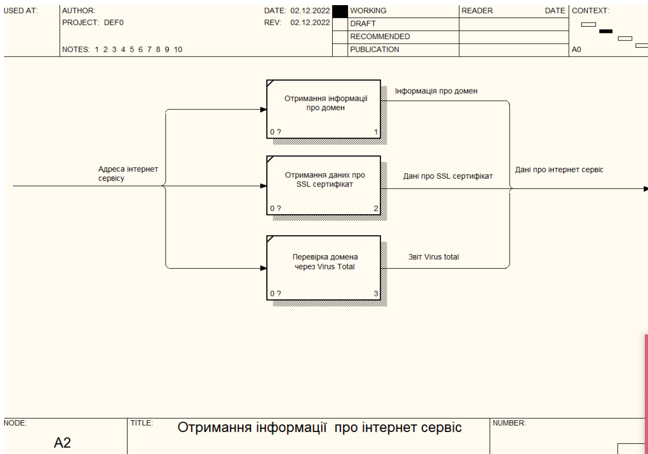
Рисунок 1.5 – Діаграма декомпозиції другого рівня для процесу отримання інформації про інтернет сервіс
