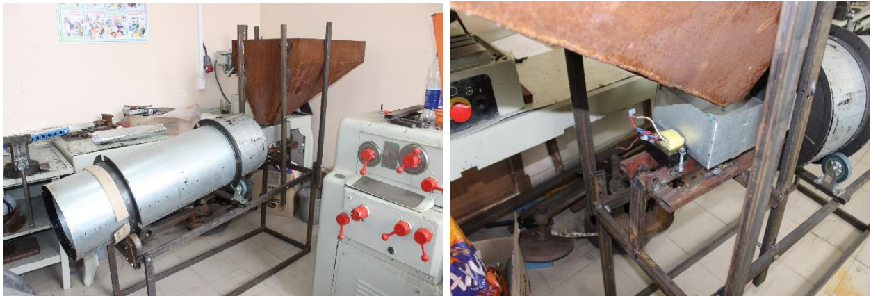
Рис. 3.1. Експериментальне встановлення барабанного протруювача Відповідність отриманих результатів у реальних умовах із віртуальною моделлю представлена рис. 3.2.
