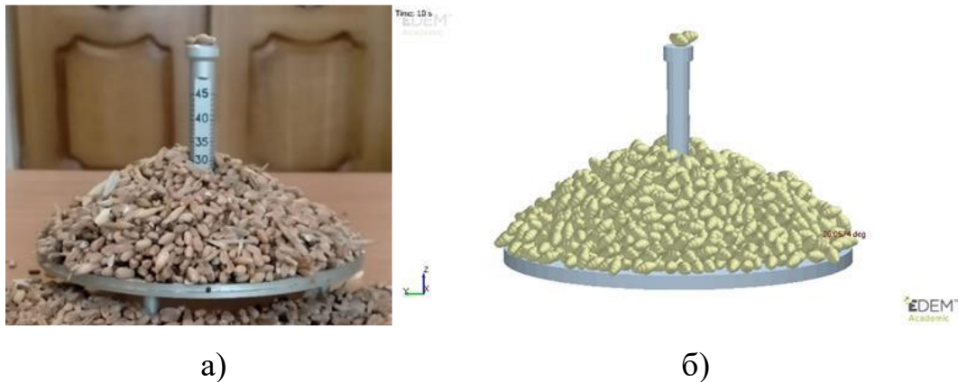
Рис. 3.8. Звіряння кута природного схилу насіння пшениці: а) приладом УВТ-3; б) на віртуальній моделі
