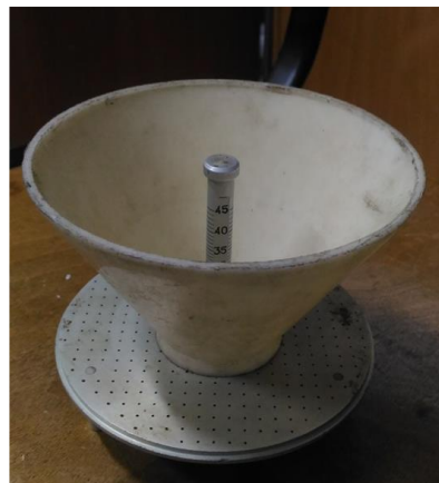
Рис. 3.4. Прилад УВТ-3 для визначення природного кута схилу зернових матеріалів
