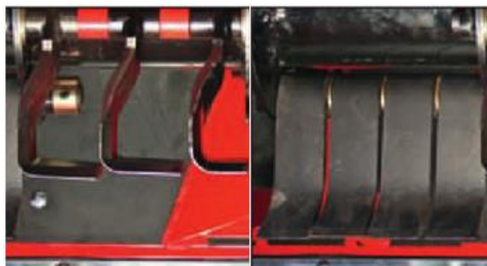
Рис. 1.14. Варіанти ножів Очисник головока : а - L – подібний ніж; б – ложкоподібний ніж [2, 4, 11].
