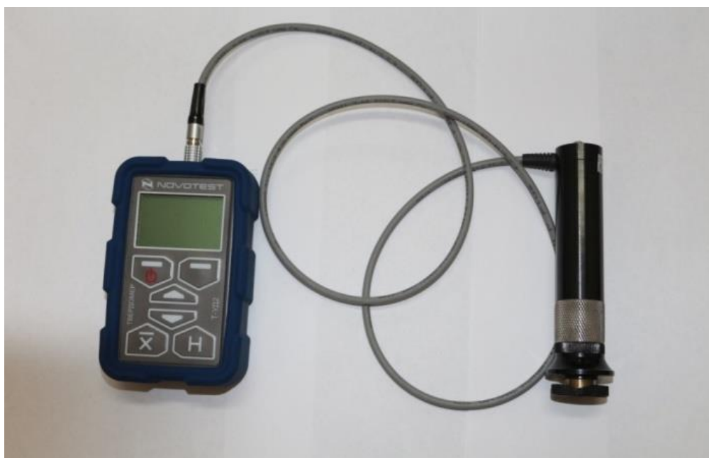
Рис. 2.2. Мікротвердомір Т-УД2, який використовується для визначення мікротвердості поверхні тертя робочих органів ґрунтообробних машин.
