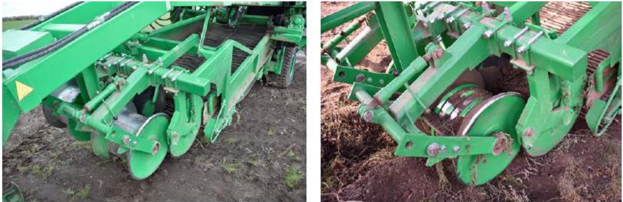
Рис. 3.2. Загальний вигляд серійного та вдосконаленого котка з кільцями комбайна ККР – 2
