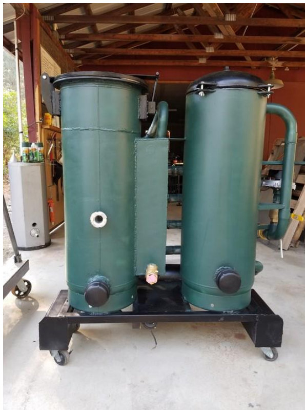
Рис. 1.1 Загальний вигляд газифікатора ( https://www.linkedin.com/pulse/building-downdraft-wood-gasifier-steven-honkus )
