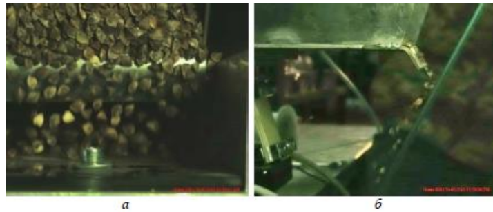
Рис. 2.2. Кадри високошвидкісної зйомки: а – біля верхнього торця скатного лотка; б – збоку
