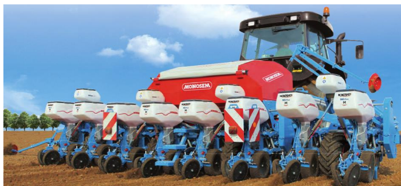
Рис. 2.3. Сівалка пневматична навісна Monosem NG Plus
