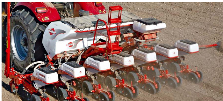
Рис. 2.1. Пневматична сівалка Khun Maxima
