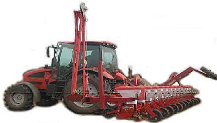
Рис. 2.4. Сівалка бурякова пневматична причіпна широкозахватна СКПП-12
