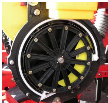
Рис. 2.11. Висівний апарат зі струшувачем насіння
