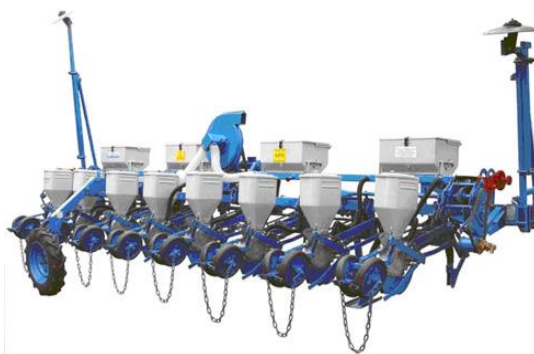
Рис. 2.2. Універсальна пневматична сівалка УПС-8 Конструктивні особливості сівалки.
