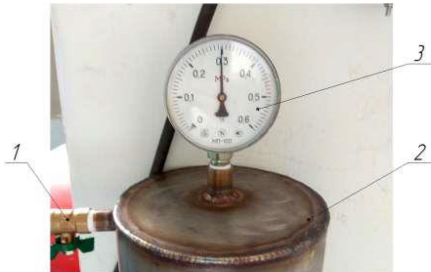
Рис. 3.9. Місткість з дезінфікуючим розчином для визначення тиску робочої рідини: 1 – кран регулювальний; 2 – ємність з дезінфікуючим розчином; 3 – манометр МП-100
