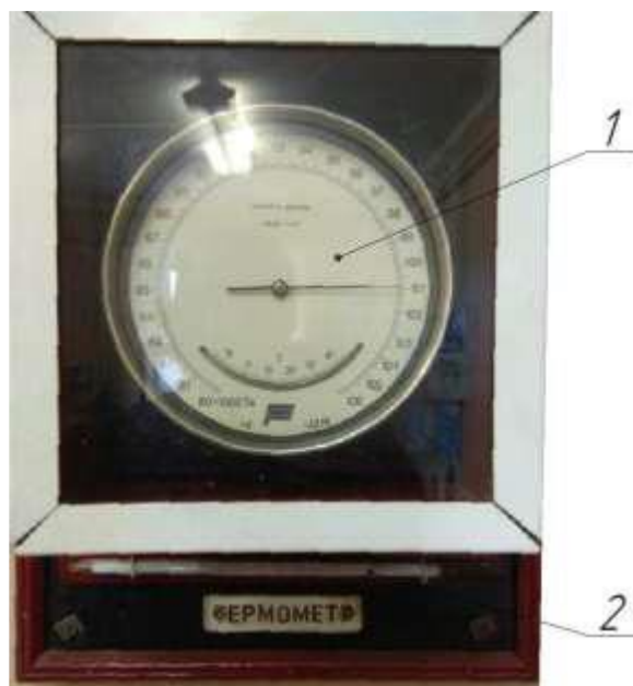
Рис. 3.10. Барометр-анероїд БАММ-1: 1 – барометр; 2 – термометр
