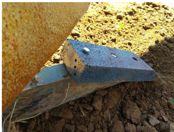
Рис. 2.1. Спосіб кріплення робочих органів чизельного плуга: а, б
