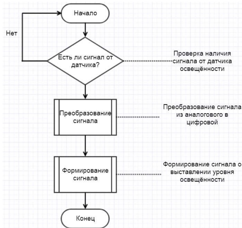
Рисунок 16 - Граф-схема алгоритму димування вуличного освітлення
