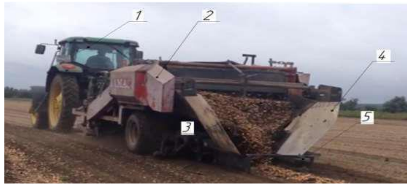
Рис. 3.5. Агрегат для збирання цибулі-сіянки: 1 – трактор John Deer; 2 – машина для збирання цибулі-сіянки "Амас D - 2"; 3 – роликівий сепаратор відділення цибулин від ґрунтових домішок; 4 – звужувальний лоток; 5 – утворювач валка.
