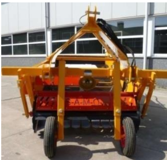
Рис. 1.9. Лемешний копач цибулі фірми Samon (Голландія) [5].
