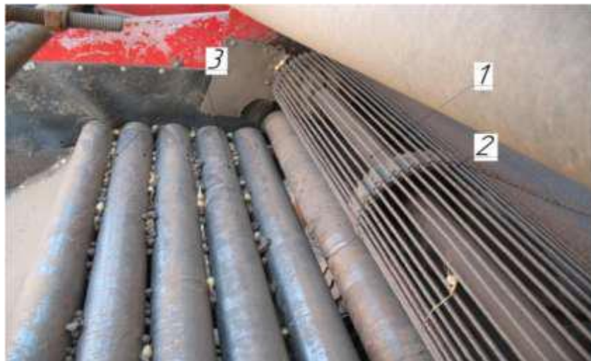
Рис. 3.4. Загальний вигляд роликового сепаратора відділення цибулин від ґрунтових домішок машини для збирання цибулі-сіянки: 1 – елеватор прутковий; 2 – валець приймальний; 3 – вальці
