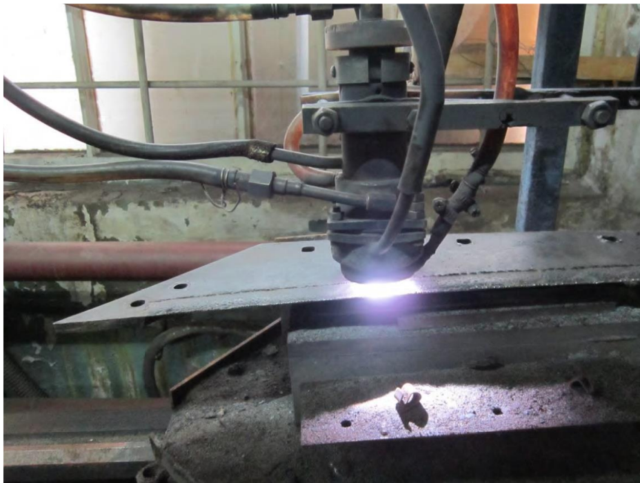
Рис. 3.2. Технологічний процес нанесення зносостійкого твердосплавного покриття плазмовим наплавленням у середовищі стисненого повітря на лезо лемеша
