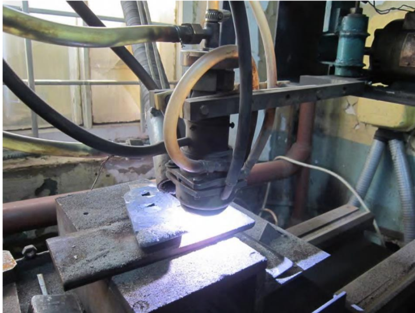
Рис. 3.3. Технологічний процес нанесення зносостійкого твердосплавного покриття плазмовим наплавленням у середовищі стисненого повітря на лезо долота
