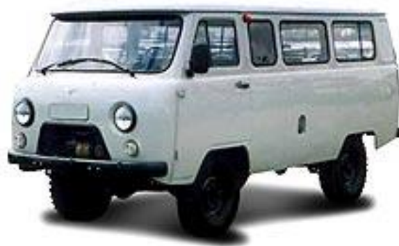
Рис. 1.6. Пересувний ремонтно-діагностичний пост для тракторів і самохідних машин КІ-28016 на базі автомобіля УАЗ
