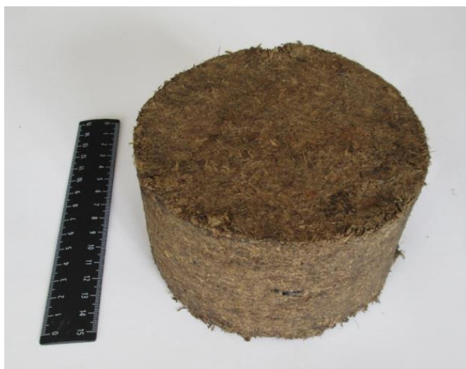
Рис. 1.16. Брикет паливний, d = 120 мм (з безпідстилкового гною ВРХ)
