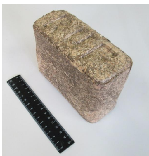
Рис. 1.13. Брикет паливний (із соснової тирси та безпідстилкового гною ВРХ)
