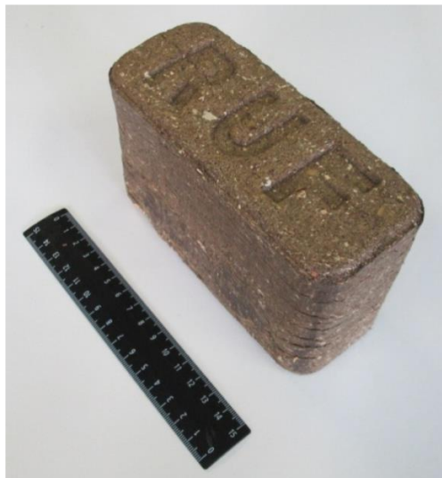
Рис. 1.14. Брикет паливний (з безпідстилкового гною ВРХ)
