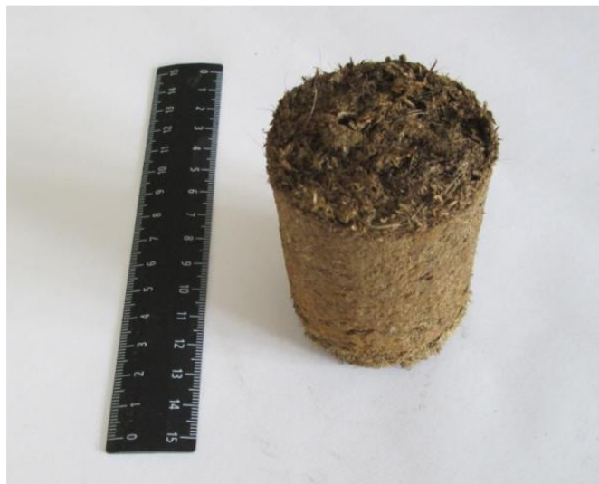
Рис. 1.15. Брикет паливний, d = 60 мм (з безпідстилкового гною ВРХ)
