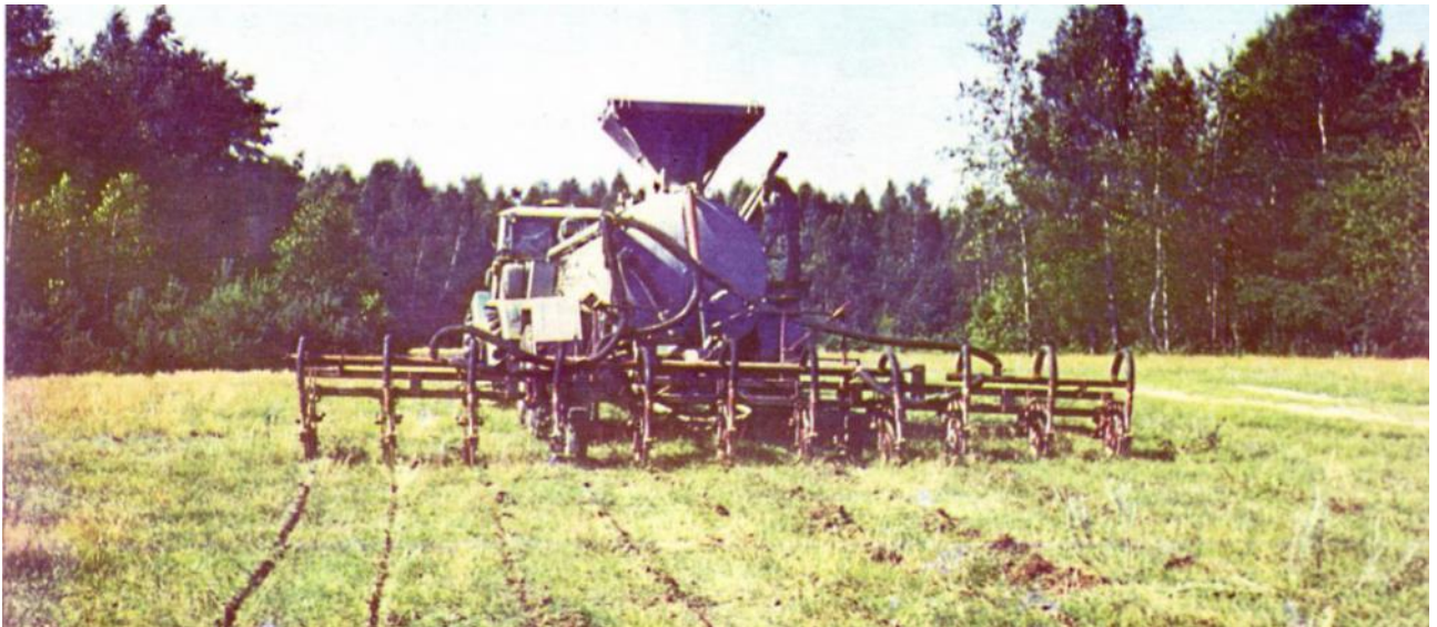
Рис. 3.2. Процес роботи машини для внесення рідких меліорантів
