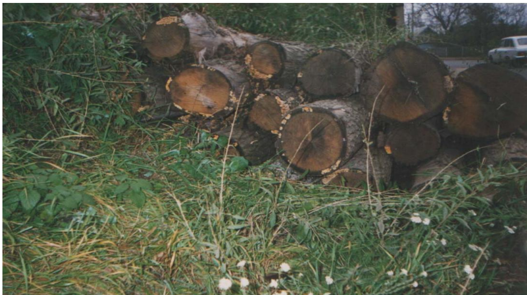
Рис. 3.4. Периферійна гніль на дубових сортиментах від стереума шерстистого Stereum hirsutum (Willd) Pers.
