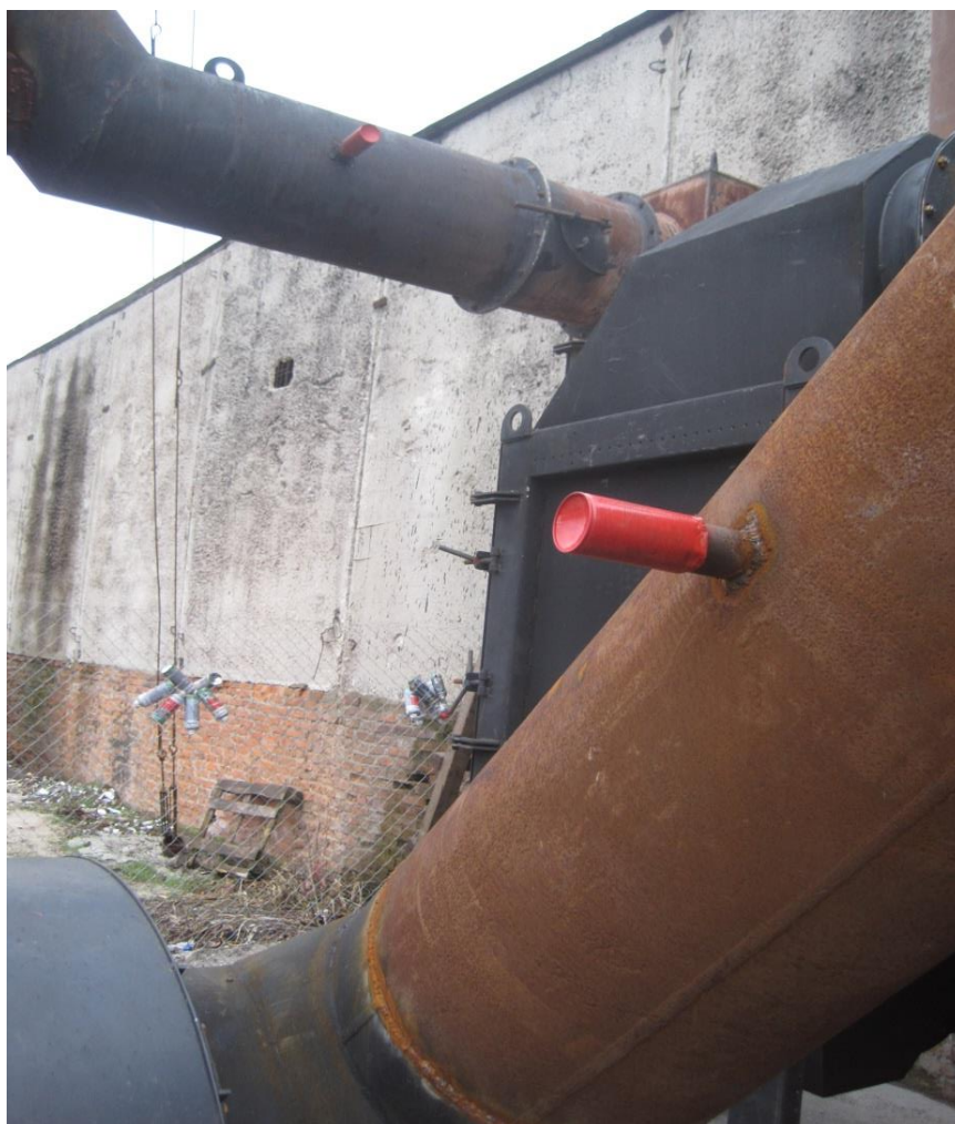
Рис. 7 Розміщення портів для замірів концентрації газів у викидах
