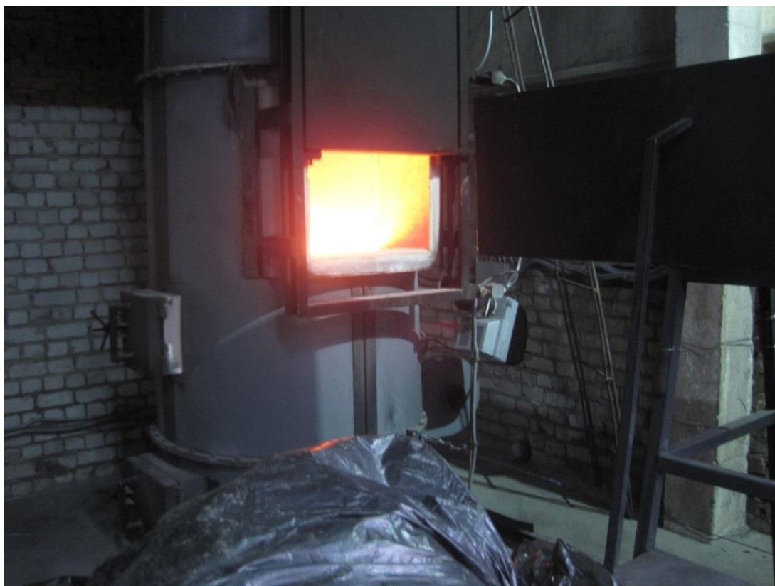
Рис.8. Шлюзова камера завантаження та камера спалювання УТ-500Д
