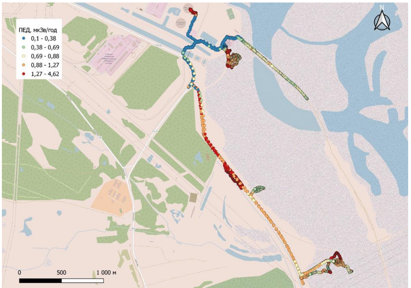
Рис.6. Показники вимірів ПЕД за допомогою трекер-дозиметра bGeigie Nano на території водойми-охолоджувача ЧАЕС
