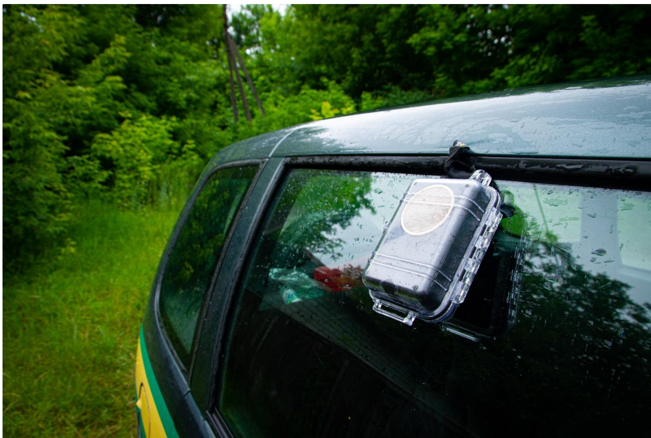
Рис. 3. Трекер-дозиметр bGeigie Nano на службовому транспорті
