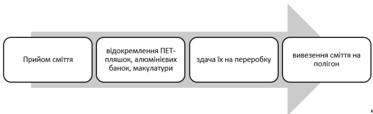
Рис. 3.12. Етапи роботи сміттесортувальної станції
