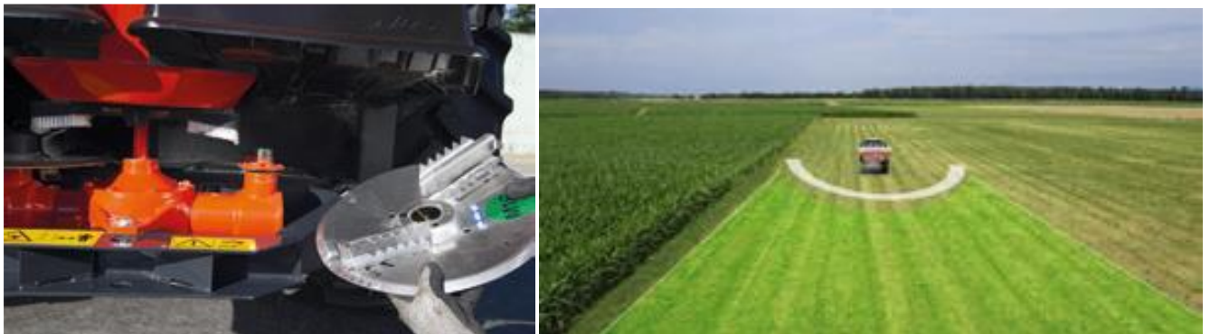
Рис. 1.5. Розкидні диски MDS (Multi-Disc-System)
