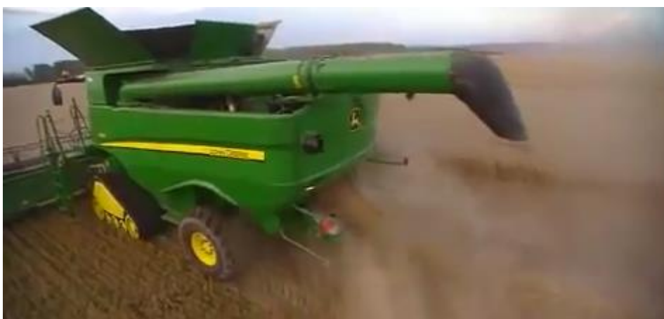
Рис. 1.4. Розподіл подрібненої соломи при збиранні озимої пшениці комбайн X9 від John Deere
