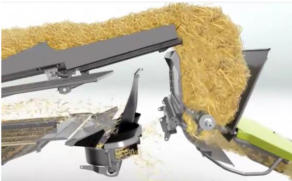
Рис. 1.2. Технологічна схема роботи подрібнювача соломи ACTIVE SPREADER від CLAAS
