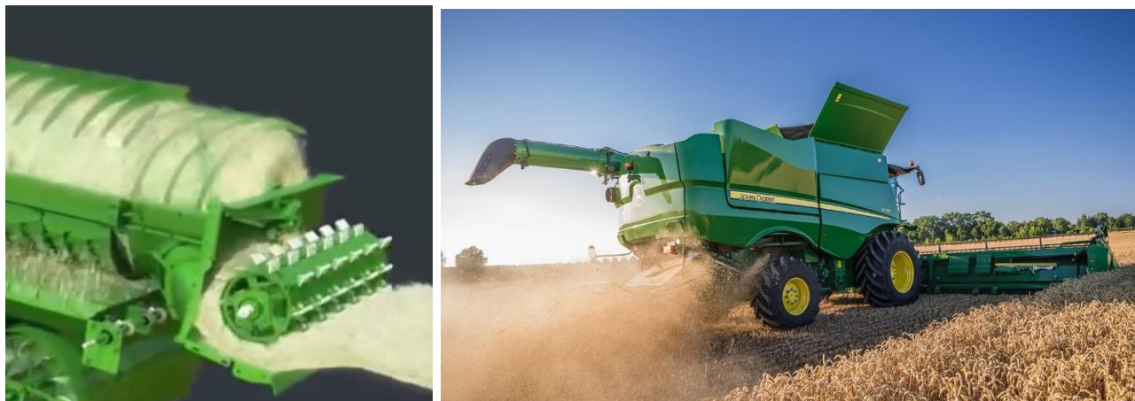
Рис.1.3. Подрібнювач соломи штифтового типу комбайна S790 від John Deere
