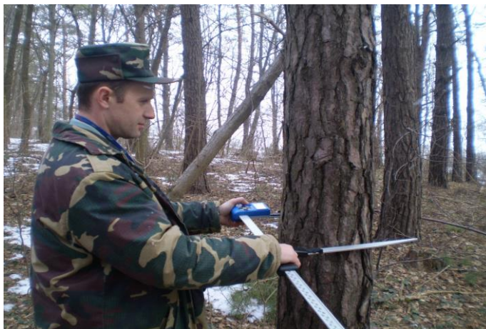
Рис. 3.5. Наземна таксація лісу за допомогою маркувального пристрою.
