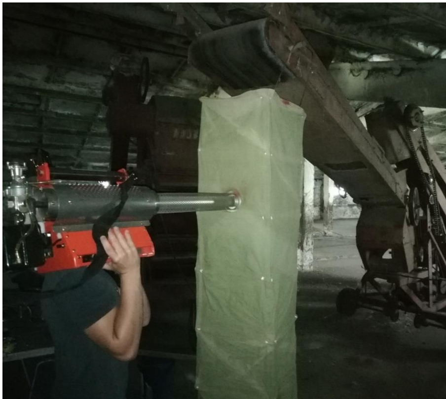
Рис. 3.4. Загальний вигляд пристрою для обробки насіння гарячим туманом.
