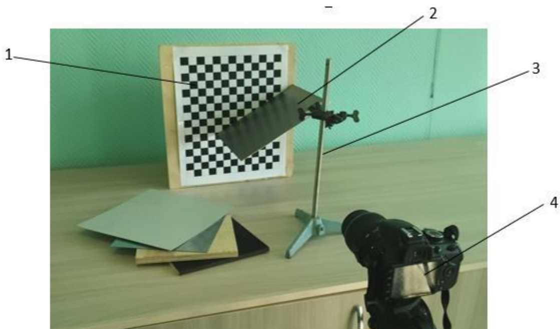
Рис. 2.3. Лабораторна установка для дослідження процесу руху насіння: 1 – вимірювальна діаграма; 2 – похила полиця; 3 – штатив; 4 – камери Nikon D5200.
