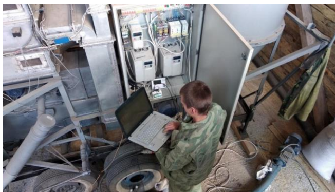
Рис. 2.10. Шахта і шафа системи автоматики дослідного зразка мобільної універсальної шахтної аерожолобної сушарки СУША-М із пристроєм своєчасного виведення зерна із сушильної камери.
