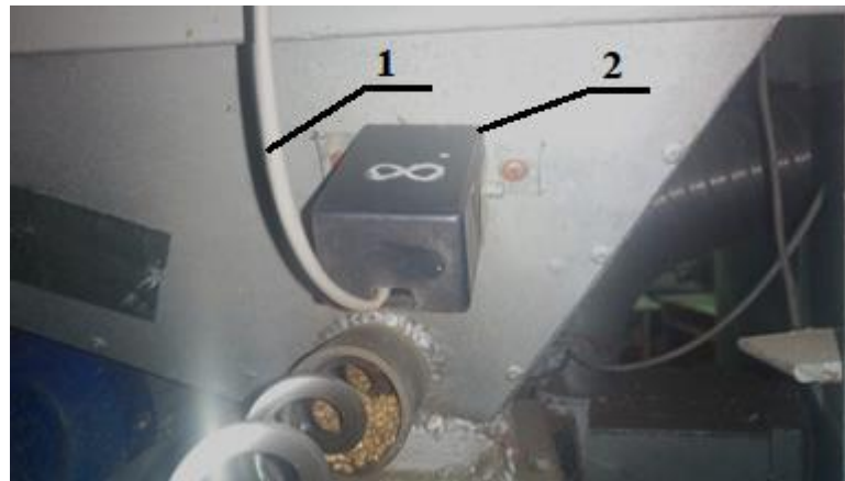
Рис. 2.8. Пірометричний датчик встановлений в аерожолобну сушарку киплячого шару 1 – інформаційний кабель, 2 – пірометричний датчик.
