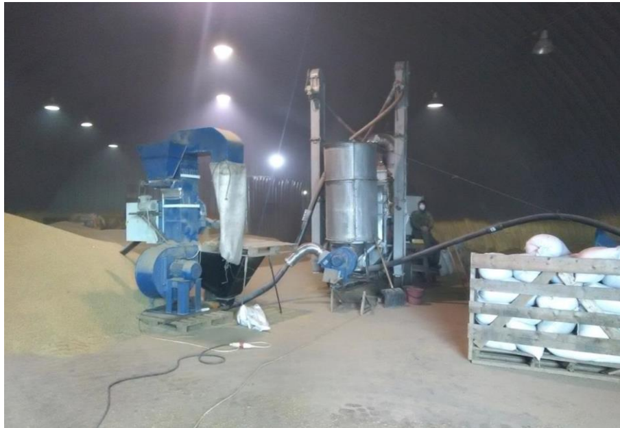
Рис. 2.13. Виробничі випробовування сушарки.
