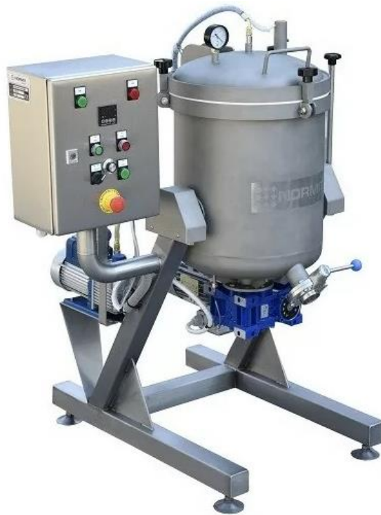
Рис. 1.6. Гомогенізатор молока вакуумний VMG фірми FoodTechProcess (Словаччина) [17]
