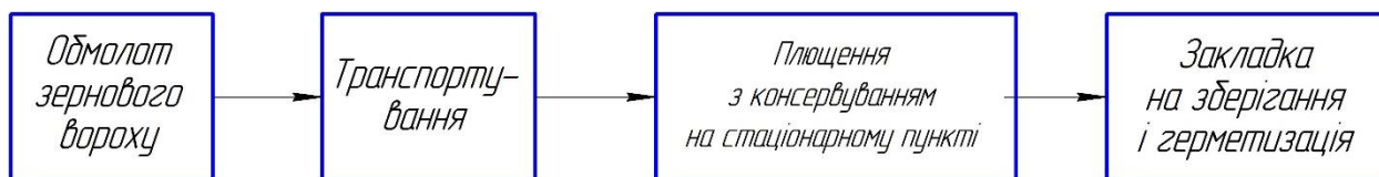
Рис. 1.3. Технологічна схема виробництва плющеного фуражного зерна на стаціонарному пункті
