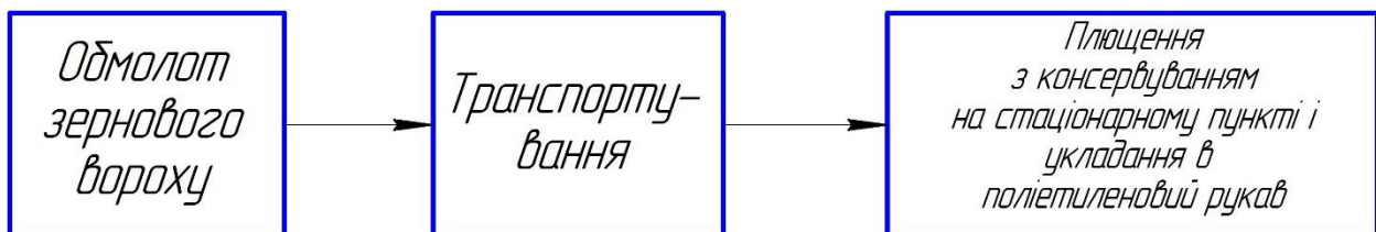
Рис. 1.4. Технологічна схема виробництва плющеного фуражного зерна на стаціонарному пункті з укладанням у поліетиленовий рукав.
