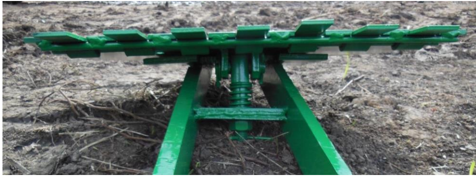
Рис 2.3. Загальний вигляд пружинного механізму модернізованого підкопувального робочого органу [3].
