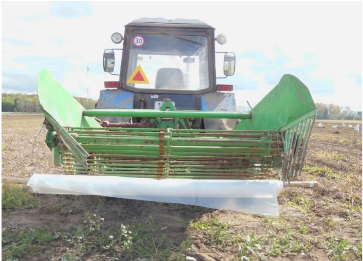
Рис. 3.4. Модернізований картоплекопач КТН проведення досліджень.
