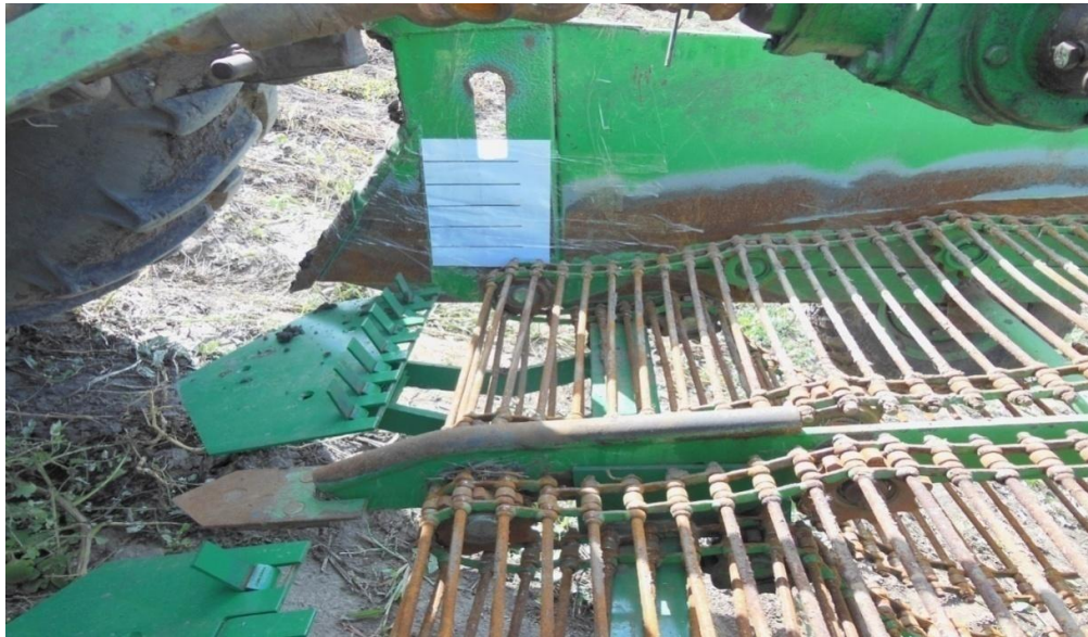
Рис. 2.5. Загальний вигляд вимірювальної шкали для фіксації висоти підскоку компонентів. Процес підскоку компонентів бульбоносного пласта в місці переходу з лемеша на прутковий елеватор знімали за допомогою камери Nikon S9200.
