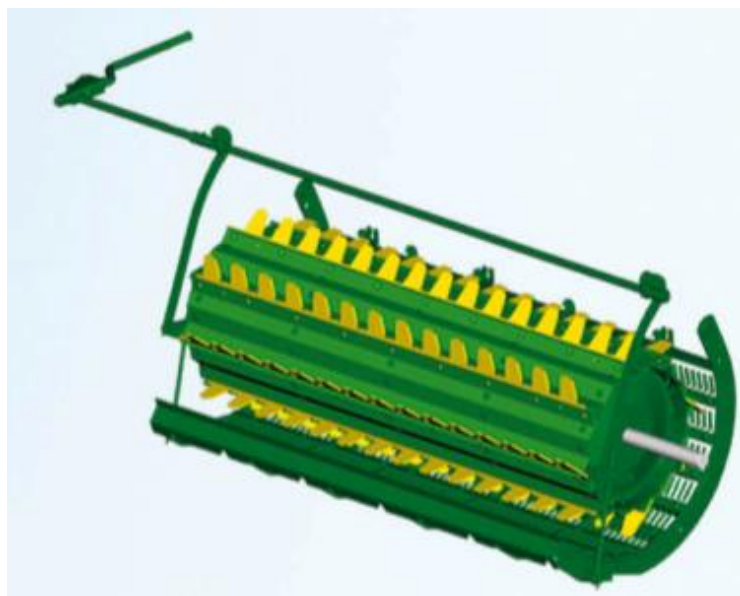
Рис. 1.4. Сепаратор соломи барабанного типу фірми Джон Дір Т-серії
