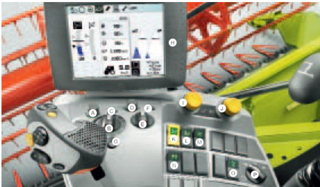
Рис. 3.1. Базові налаштування машини в режимі роботи молотарки
