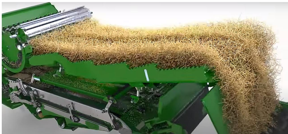
Рис. 1.2. Схема роботи клавішного соломотряса комбайна компанії Джон Дір Т-серії[2]
