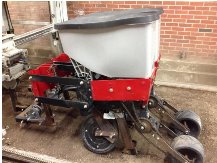
Рис. 2.5. Розроблена сівалка, прикріплена до візка
