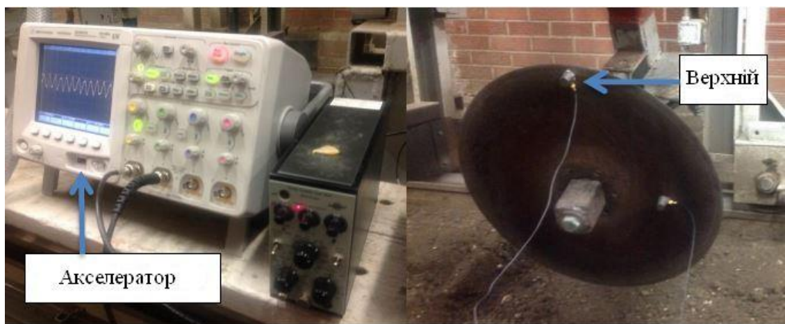
Рис. 3.1. Акселерометр для тесту на власну частоту
