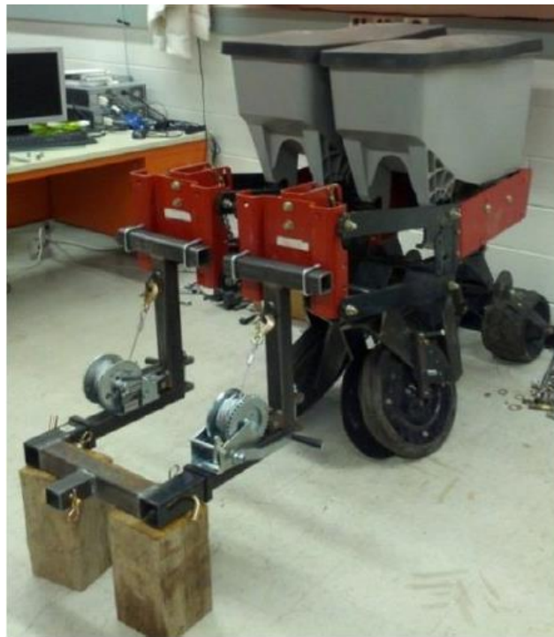
Рис. 2.3. Розроблена секція сівалки [17].
