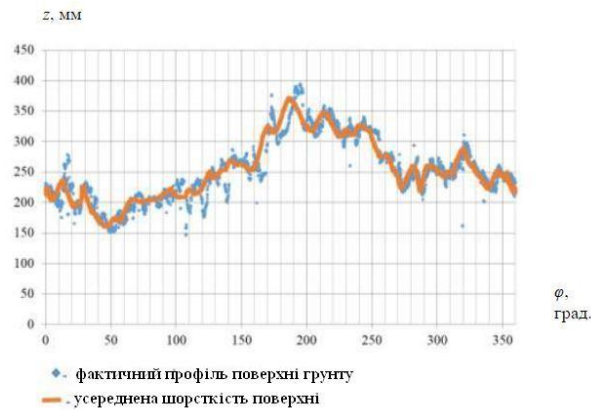
Рис. 3.1. Графік функції фактичного профілю поверхні обробленого ґрунту з усередненням для визначення його мікрорельєфу.
