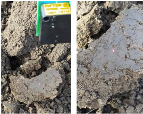
Рис. 2.12. Фрагмент визначення грудкуватості ґрунту: а) промінь лазерного датчика спрямований на грудку; б) лазерний промінь проектується на грудці.
