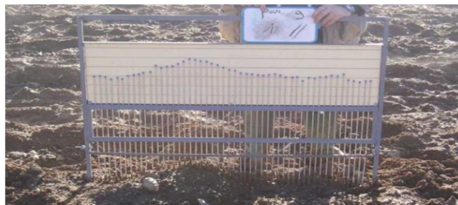
Рис. 1.5. Приклад застосування штирвого профілометра для визначення мікрорельєфу ділянки поля [18].
