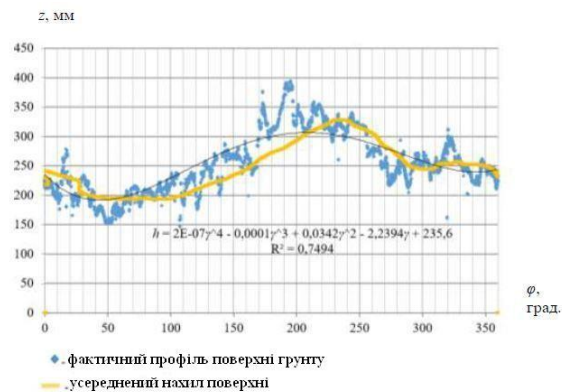
Рис. 3.3. Графік функції фактичного профілю поверхні обробленого ґрунту з усередненням для визначення його нахилу.
