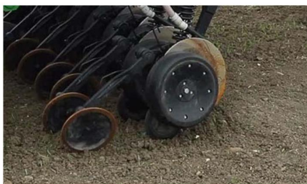
Рис. 1.2. Посівні секції з дисковими сошниками: а – посівна секція сівалки John Deere 750a Drill Related; б – посівна секція сівалки АП-332.
