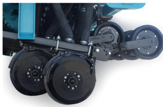
Рис. 1.2. Посівні секції з дисковими сошниками: а – посівна секція сівалки John Deere 750a Drill Related; б – посівна секція сівалки АП-332.
