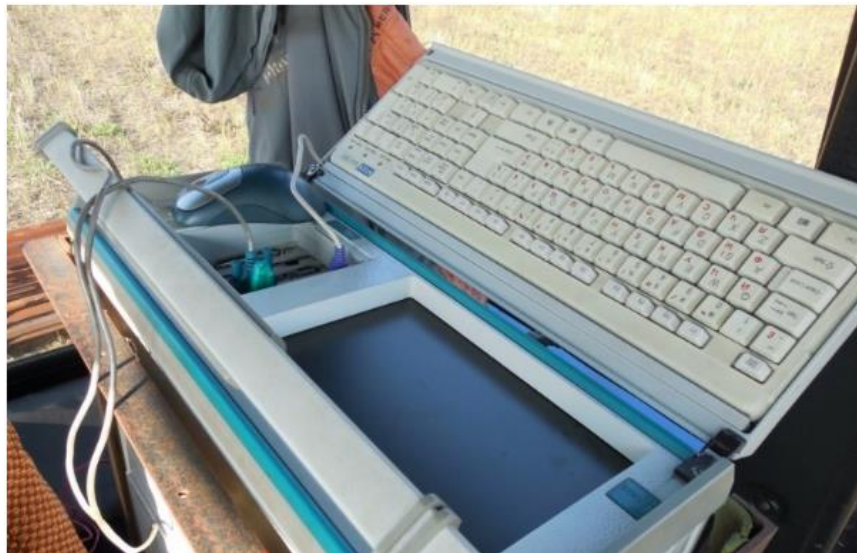
Рис. 2.7. Вимірювально-обчислювальний комплекс MIC-400D під час проведення лабораторно-польових експериментів
