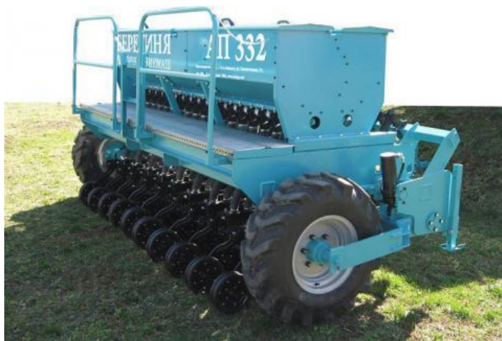
Рис. 1.8 Сівалка прямого посіву АП-322 [3].
