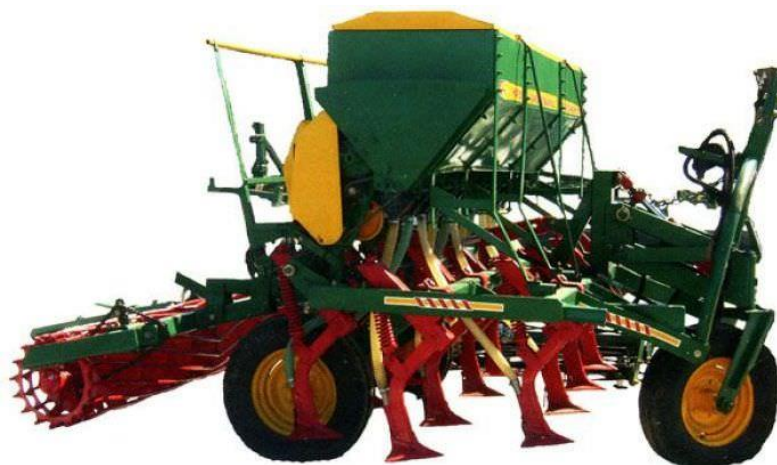
Рис. 1.6. Сівалка зернова стерньова СЗС-2,8 [3].
