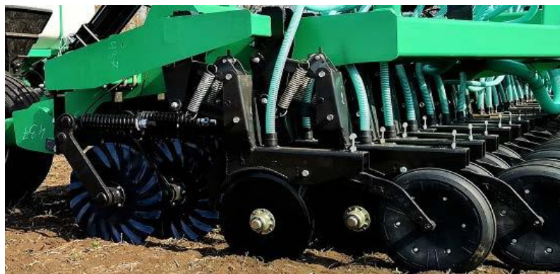
Рис. 1.1. Посівна секція Salford 520.
