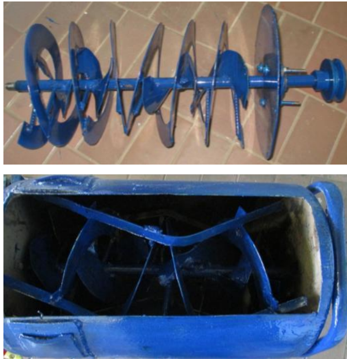
Рис. 2.2. Змішувальні вузли з різними кроками зовнішнього та внутрішнього шнеків: а – S_2 = 80 мм; S_3 = 120 мм; б – S_2 = S_3 = 120 мм.
