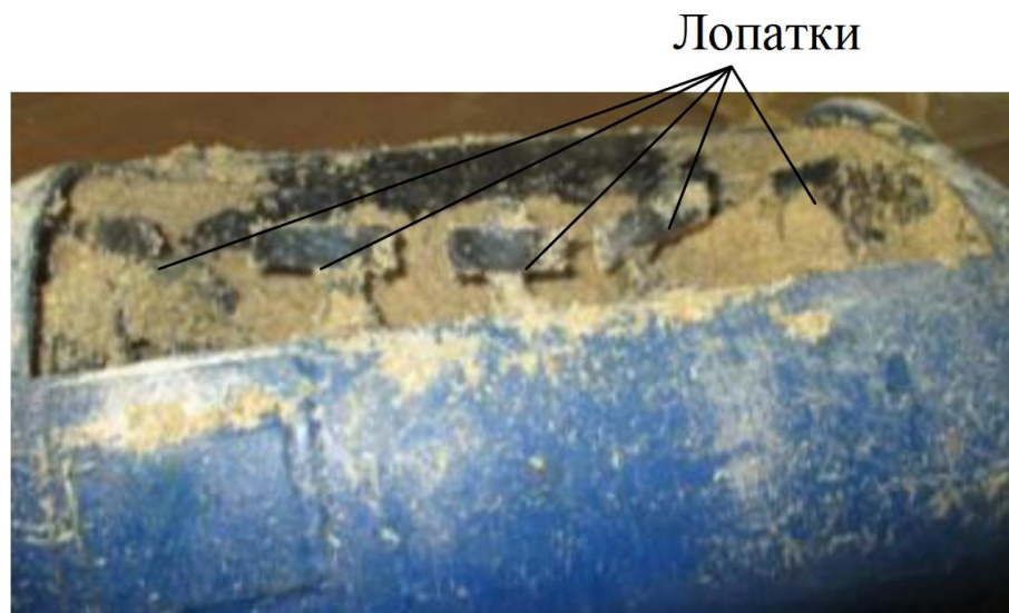
Рис. 3.7. Змішувальний вузол із лопатками
