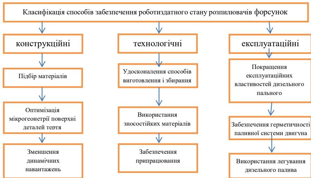
Рис. 1.4 Способи забезпечення працездатного стану прецизійних сполучень розпилювачів форсунок
