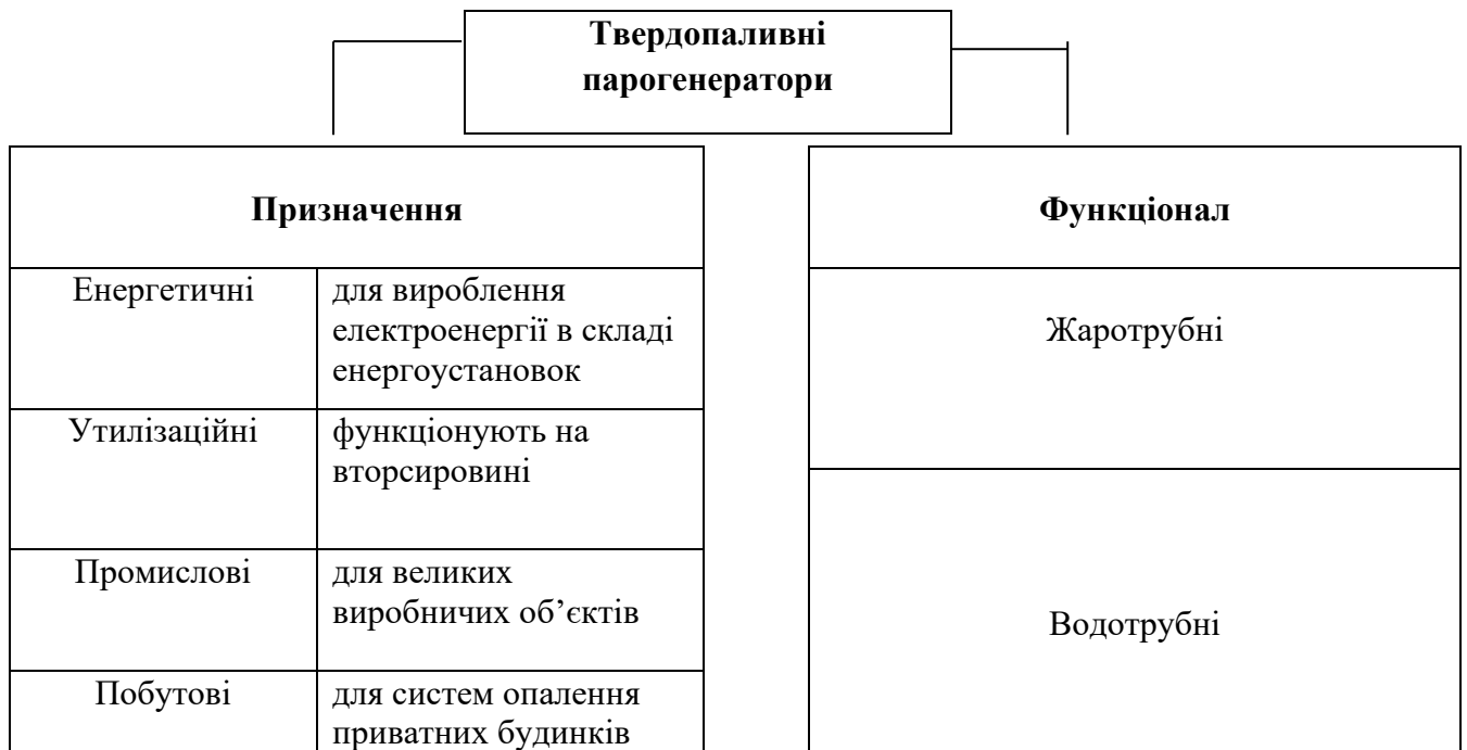
Рис. 3.1. Призначення та функціонал парогенераторів
