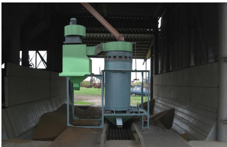
Рис. 3.8. Повітряний відцентрово-решітний сепаратор на випробуваннях.
