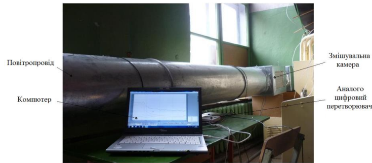
Рис. 2.3. Експериментальна установка для осушення повітря у тваринницьких приміщеннях [21].
