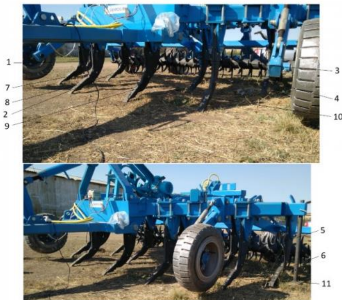
Рис. 2.7. Схема нумерації робочих органів комбінованого чизельного плуга для вимірювання їхньої віброактивності плуга для вимірювання їхньої віброактивності (пояснення в тексті).
