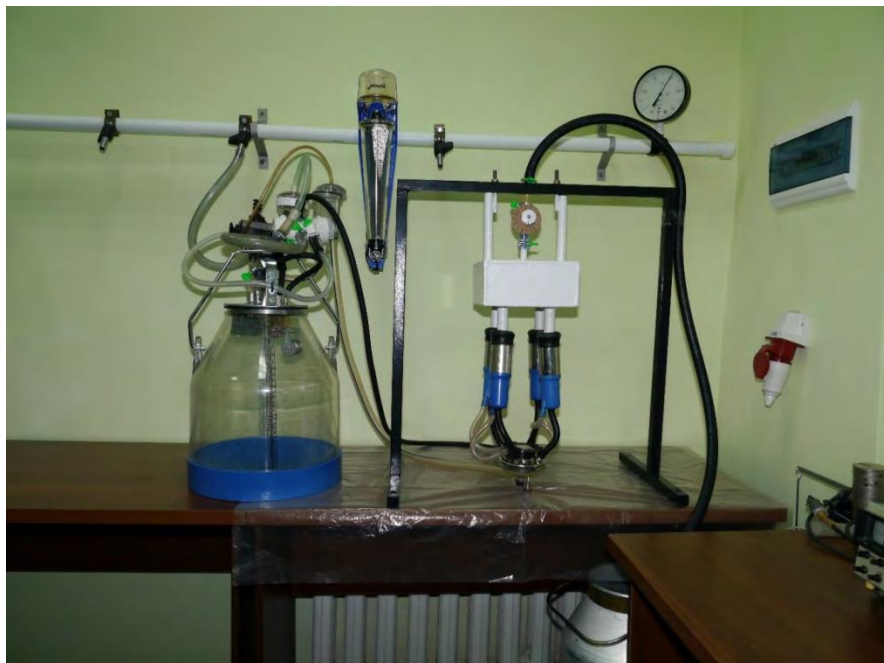
Рис. 2.8. Загальний вигляд установки для визначення часу вимкнення високочастотного блока вібропульсатора
