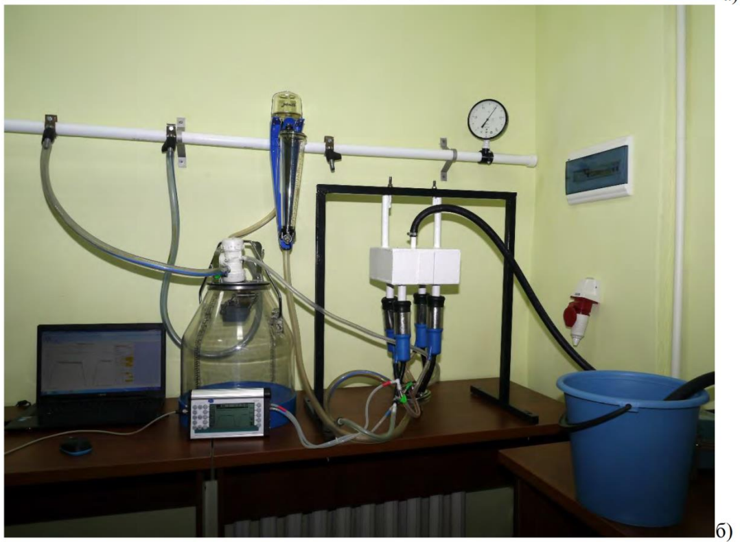
Рис. 2.5. Загальний вигляд установки для визначення пропускної спроможності доїльного апарата за вимкненого (а) і ввімкненого (б) високочастотного блоку вібропульсатора і вакуумметричного тиску відповідно – 48 і 38 кПа.
