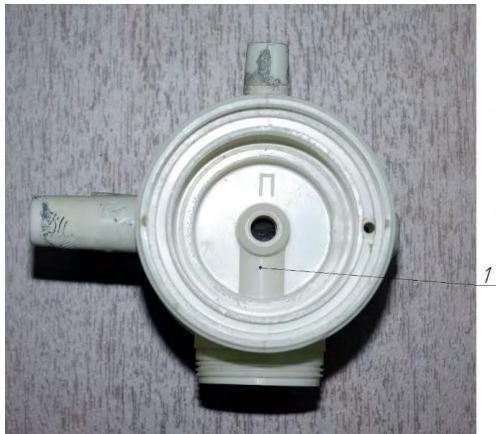
Рис. 2.16. Канали в корпусі вібропульсатора: 1 – канал атмосферного тиску низькочастотного блоку; 2 – канал атмосферного тиску високочастотного блоку.
