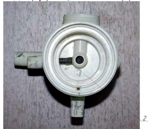
Рис. 2.16. Канали в корпусі вібропульсатора: 1 – канал атмосферного тиску низькочастотного блоку; 2 – канал атмосферного тиску високочастотного блоку.
