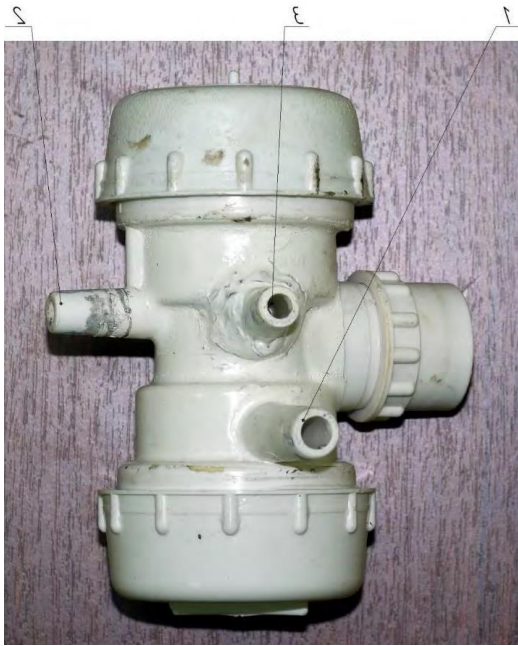
Рис. 2.15 Вібропульсатор з високочастотним блоком: 1 – патрубок постійного вакуумметричного тиску; 2 – патрубок змінного вакуумметричного тиску; 3 – додатковий керувальний патрубок
