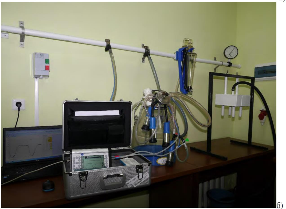
Рис. 2.3. Загальний вигляд лабораторної установки для вимірювання коливань тиску в камерах доїльних склянок за вимкненого (а) і ввімкненого (б) високочастотного блоку пульсатора та вакуумметричного тиску відповідно – 48 і 38 кПа.
