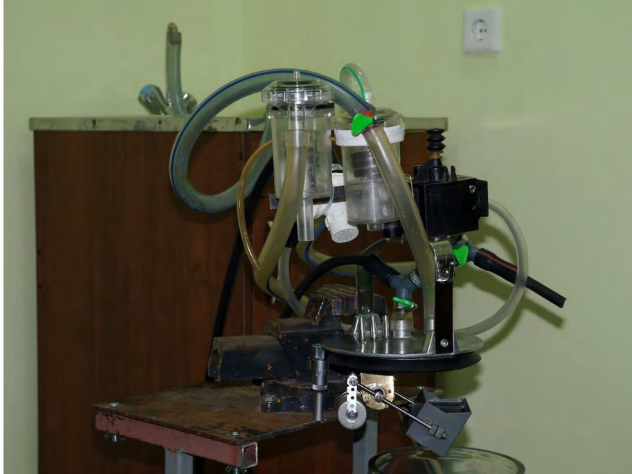
Рис. 2.7. Загальний вигляд лабораторної установки для визначення маси вантажу молоколовушки блоку керування режимом доїння.
