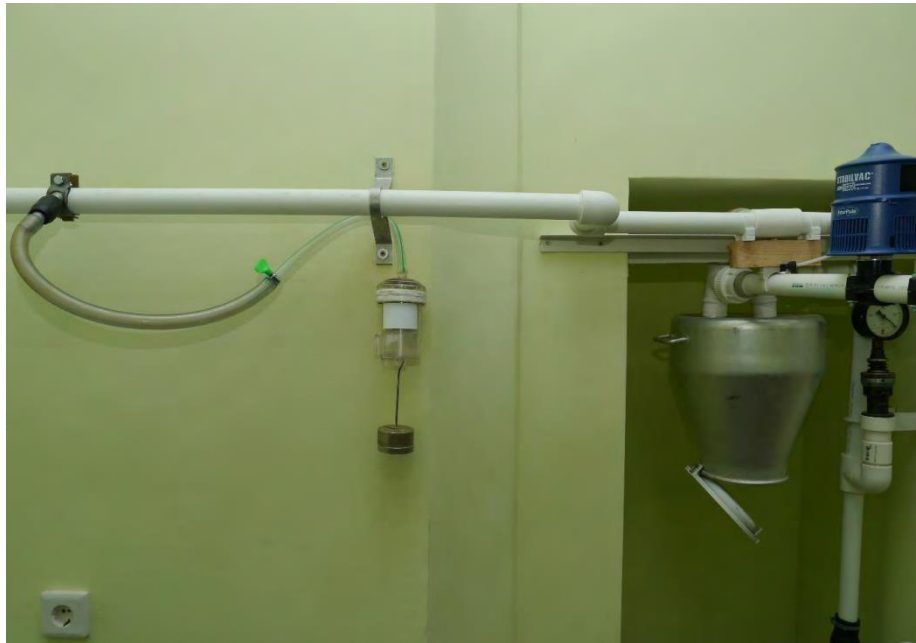
Рис. 3.5. Загальний вигляд лабораторної установки для визначення геометричних параметрів пристрою перемикання магнітного клапана [2].
