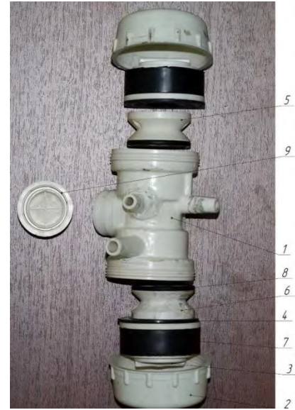
Рис. 2.16. Деталі вібропульсатора: 1 - корпус АДУ-02.210; 2 - гайка АДУ.02.061; 3 - камера АДУ.02.052; 4 - мембрана АДУ.02.053; 5 - дифузор АДУ.020.055-01; 6 - дифузор АДУ.02.055; 7 - кільце АДУ.02.056; 8 - прокладка ДД.013; 9 - гайка АДУ.02.062
