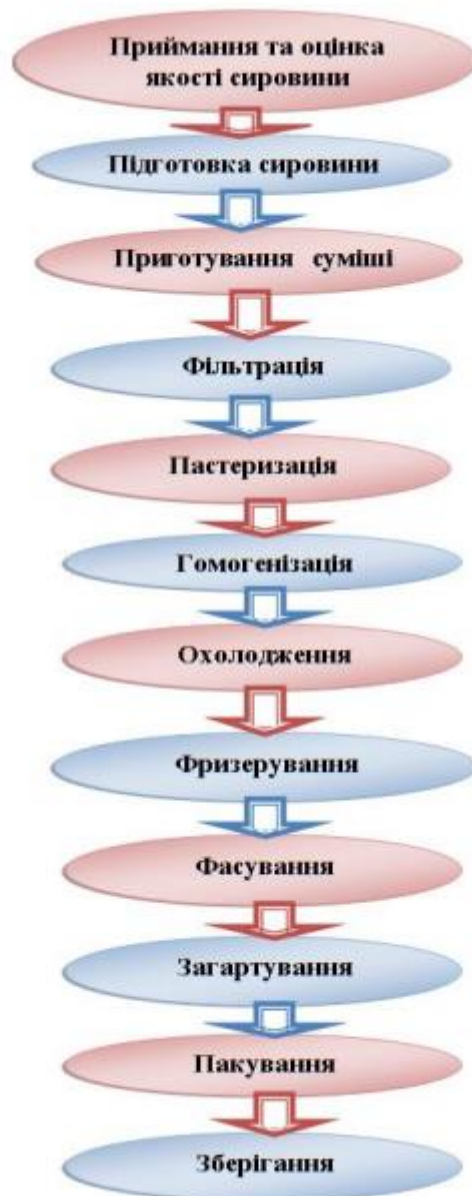
Рис. 3.19. Загальна технологічна схема виробництва морозива.
