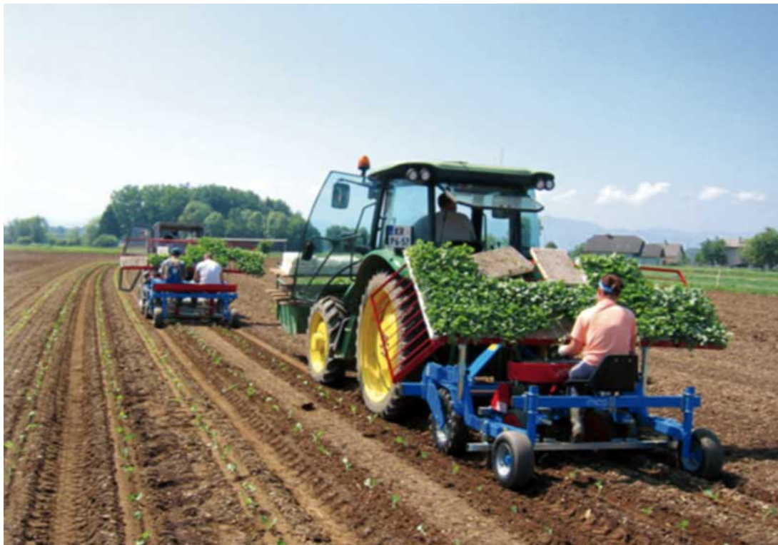
Рис. 2. Висаджування розсади за допомогою розсадосадильної машини Hortech Practica Duo
