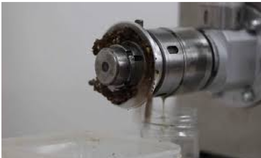
Рис. 2. Установлення виходу олії ріпаку озимого в лабораторних умовах Поліського університету
