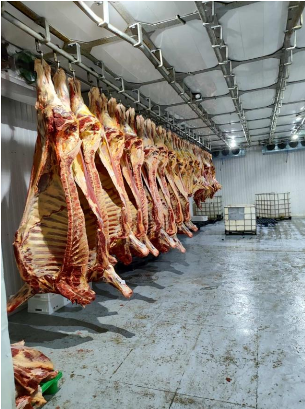
Рис. 7. Камера охолодження туш
