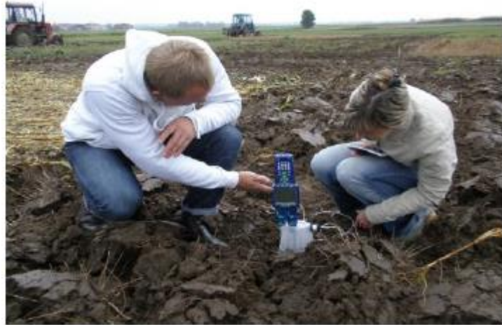
Рис. 2.12. Визначення вмісту CO_2 та температури ґрунту.
